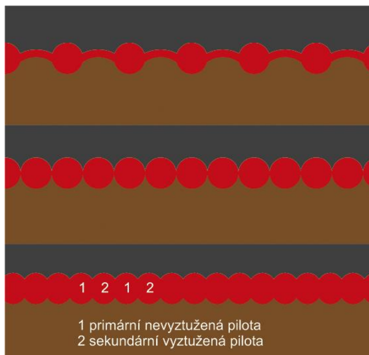
Obrázek 21: Druhy pilotových stěn - volně stojící (nahore), tangenciální (uprostřed) a převrtávané (dole) [19]
