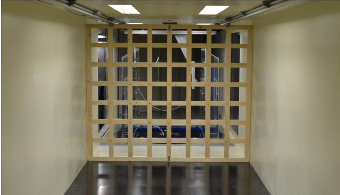
Obr. 11 Pohled na prostor pro vývoj mezní vrstvy s generátorem turbulence
