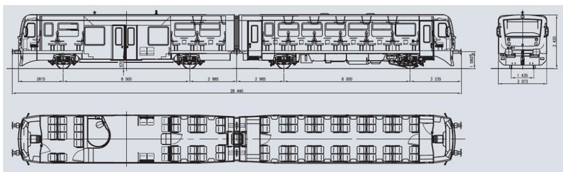
Obr. 41 Regionova řady 814 - 914: Schéma soupravy Zdroj: [15]
