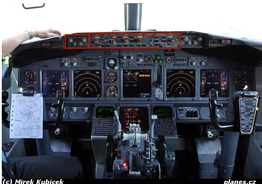
Obr. 2.1: Vyznačený MCP a EFIS panel Boeingu 737 [7]
