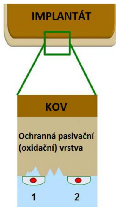
Obr.2.2: Schéma možné interakce kovového implantátu s biologickou tkání [3]
