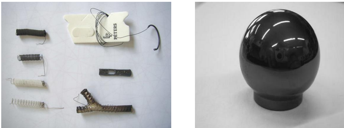
Obr.2.4: Aplikace DLC vrstev v biomedicíně. Vlevo: anastomické štíty, cévní náhrady, příchytky [26]; vpravo: hlavice kyčelního kloubu [27]
