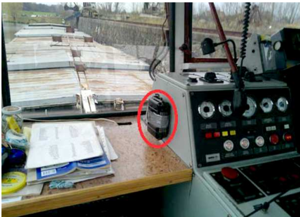
Obrázek č. 20 - Umístění jednotky OBU v prostoru kormidelny remorkéru [6]
