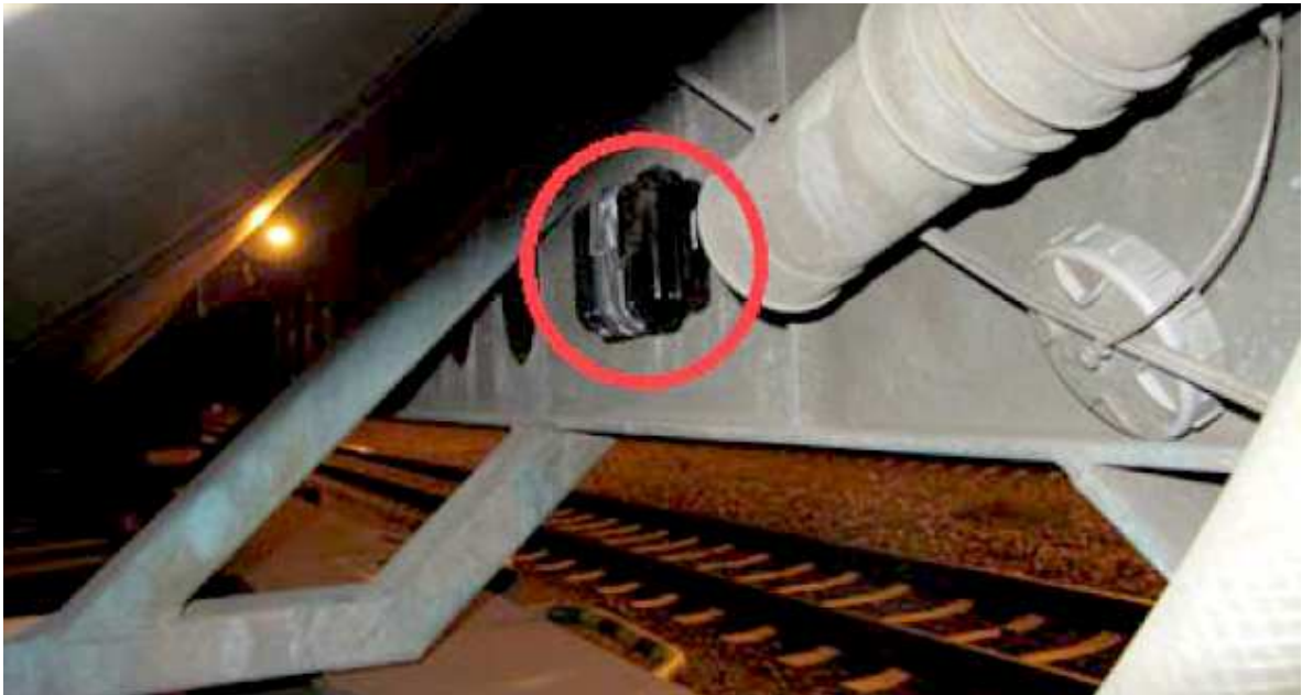
Obrázek č. 19 - Umístění jednotky OBU na v rámu cisternového kontejneru [6]
