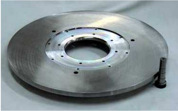
Obrázek 15 Typický třecí převod, který využívá firma DFM Engineering telescopes. Malý váleček a kolo s velkým průměrem zajistí vysoký převodový poměr. Mezi koly není mazání. Převzato z [18]
