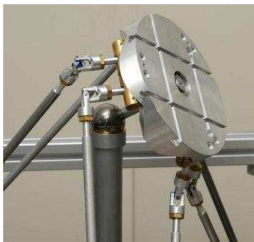
Obrázek 11 Návrh montáže pro rychlý dalekohled určený pro sledování gama záblesků. Převzato z [13]
