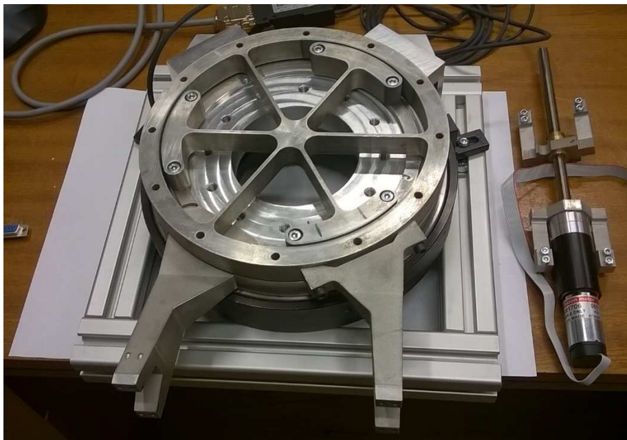
Obrázek 57 Sestavení pro experiment ověřující hysterezi
