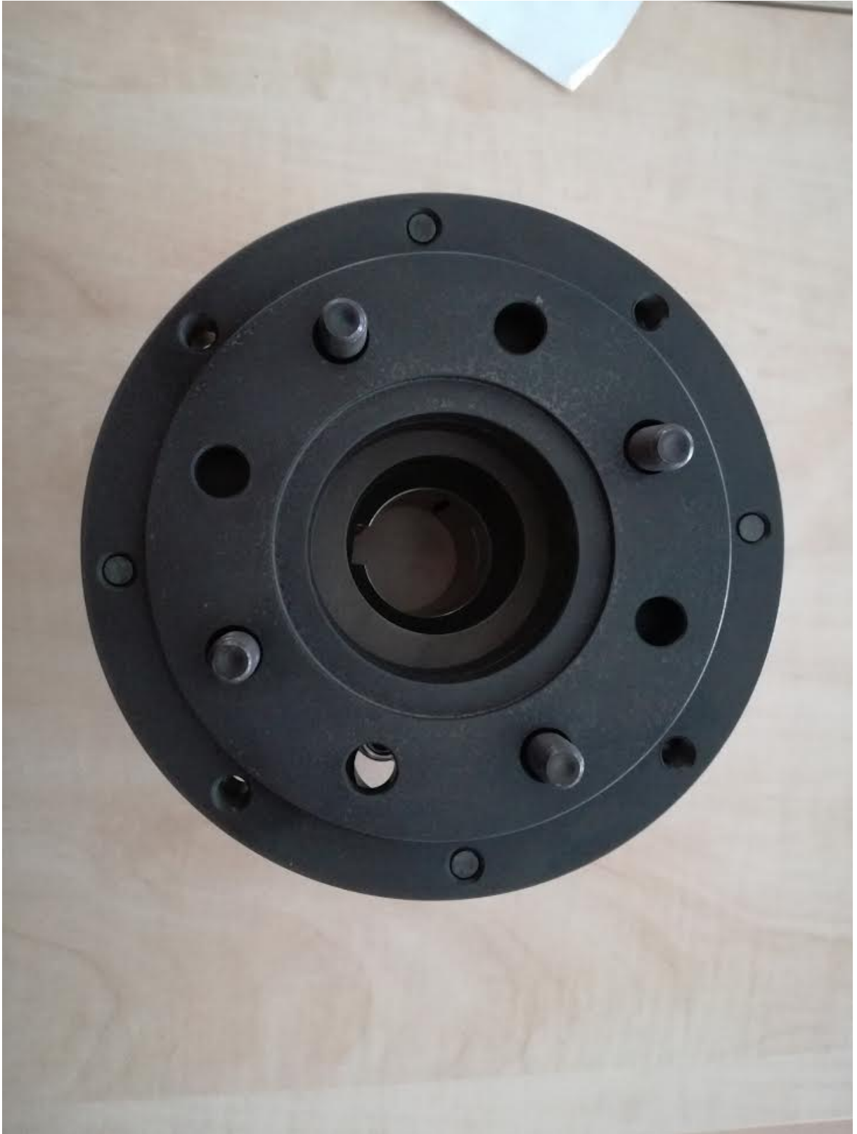
Photo 3 – Roba DS coupling top view
