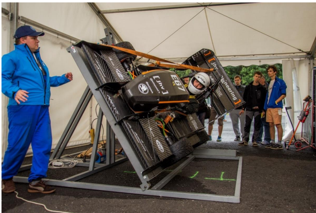
Obr. 2 – Monopost FSE.05 na tilt testu během technických přejímek na Závodech FS Czech
