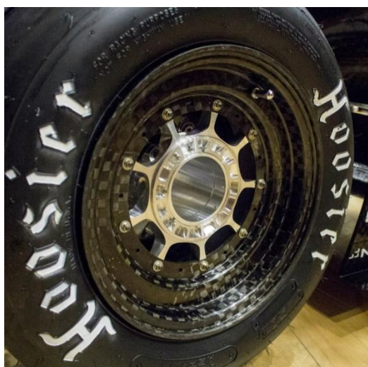
Obr. 8 – Límec vyráběný prepregovou technologií týmu ze státu Washington
