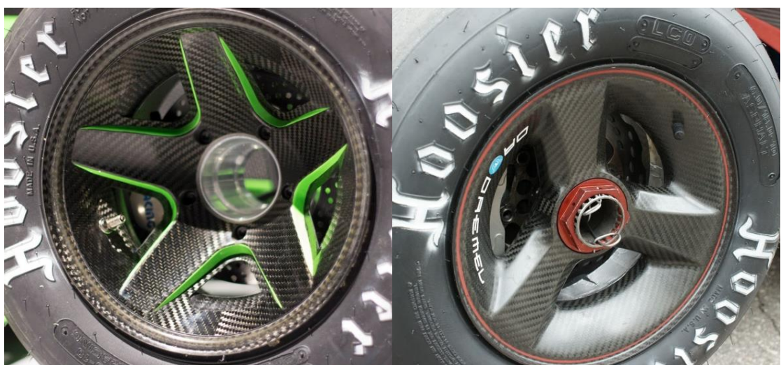
Obr. 10 – Celokompozitní ráfek s vlepěným středem týmu z Bathu
