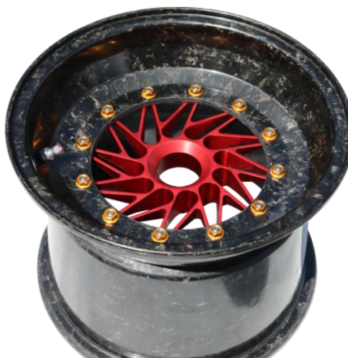
Obr. 9 – Límec firmy Black Wave vyráběný SMC technologií [18]
