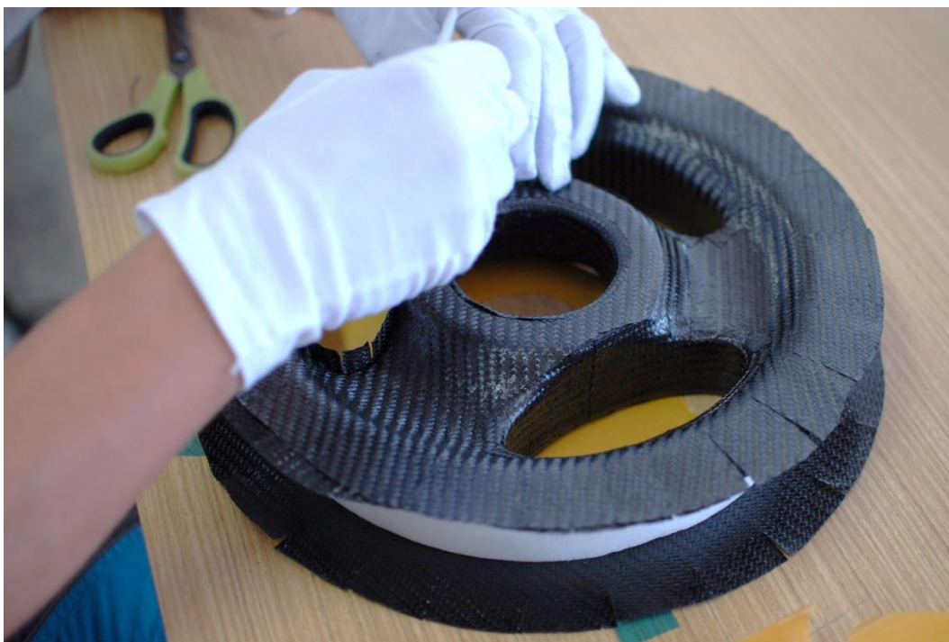
Obr. 61 – Pokládání skladby laminátu na pěnové jádro
