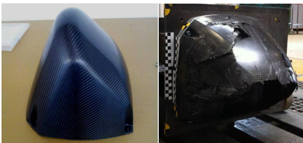
Obr. 17 - Deformační nos AMZ Zurich před a po testu [3]
