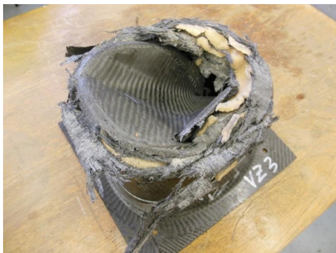
Obr. 46 - Progresivní porucha delaminací s křehkým odlamováním vzorku VZ3
