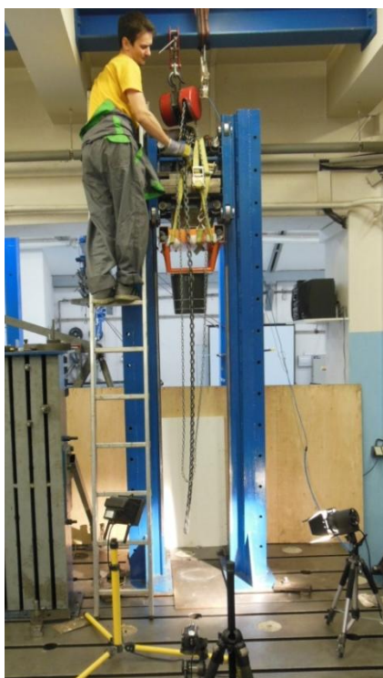
Obr. 36 - Pádová zkouška provedená Ústavem letadlové techniky ČVUT
