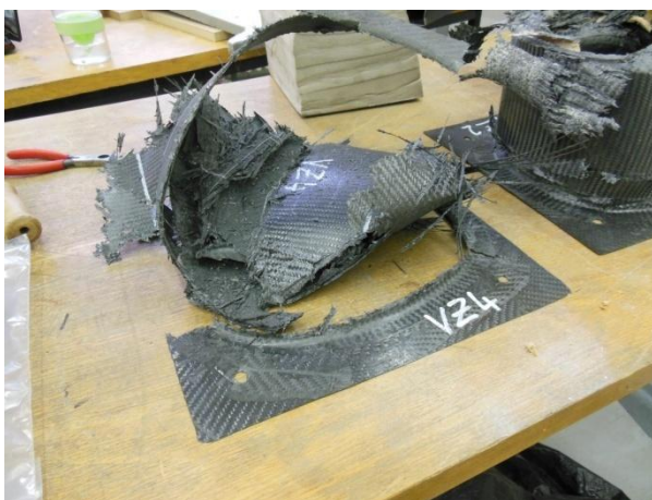
Obr. 47 - Katastrofická porucha vzorku VZ4
