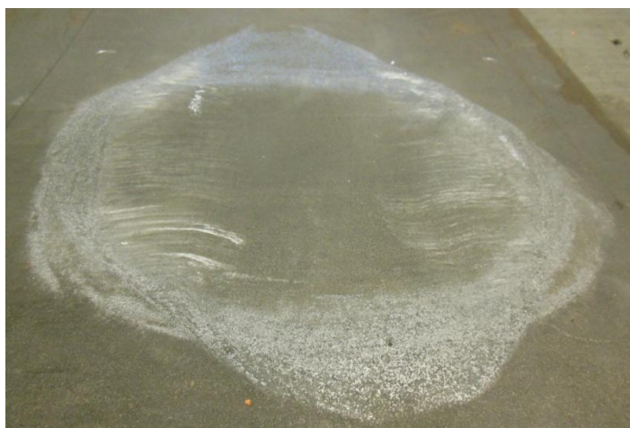
Obr. 48 - Změna drsnosti povrchu na impaktoru
