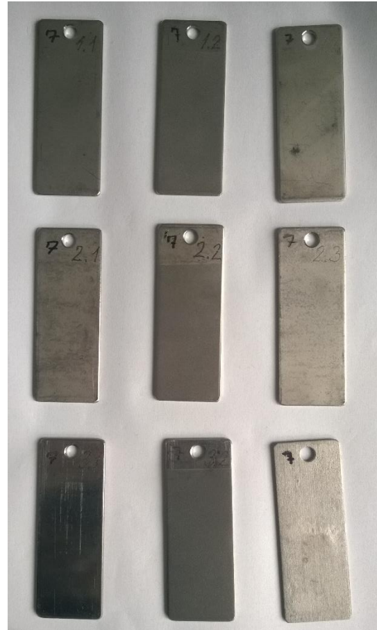
Obr. 13: Očištěné a osušené vzorky po 300 hodinách z 35°C roztoku
