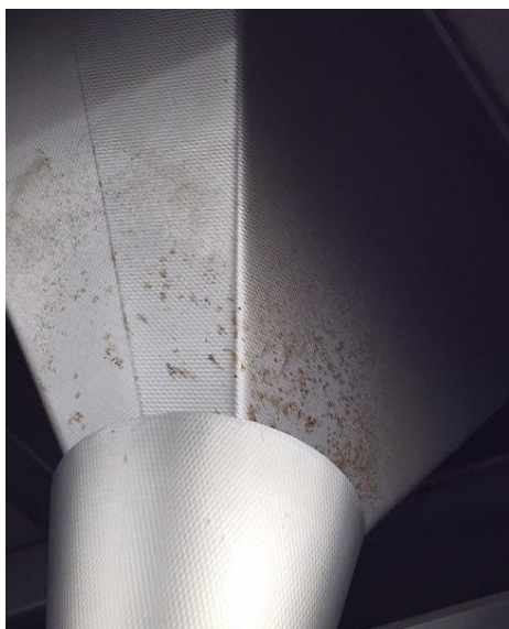
Obr.1: Koroze na svodu produktu
