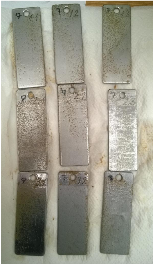
Obr. 12: Vzorky vyjmuté po 300 hodinách z 35°C roztoku
