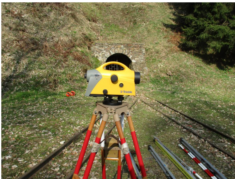
Obr. 12 - Nivelační přístroj Trimble DiNi 12T
