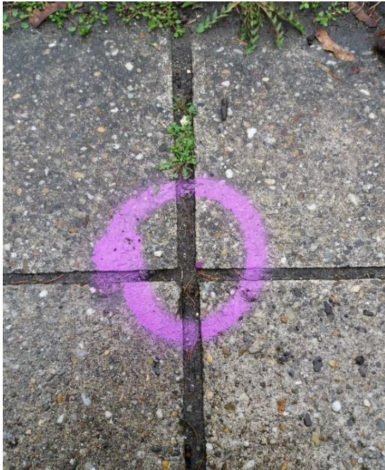
Obr. 21: Stabilizace stanoviště na rohu dlažby
