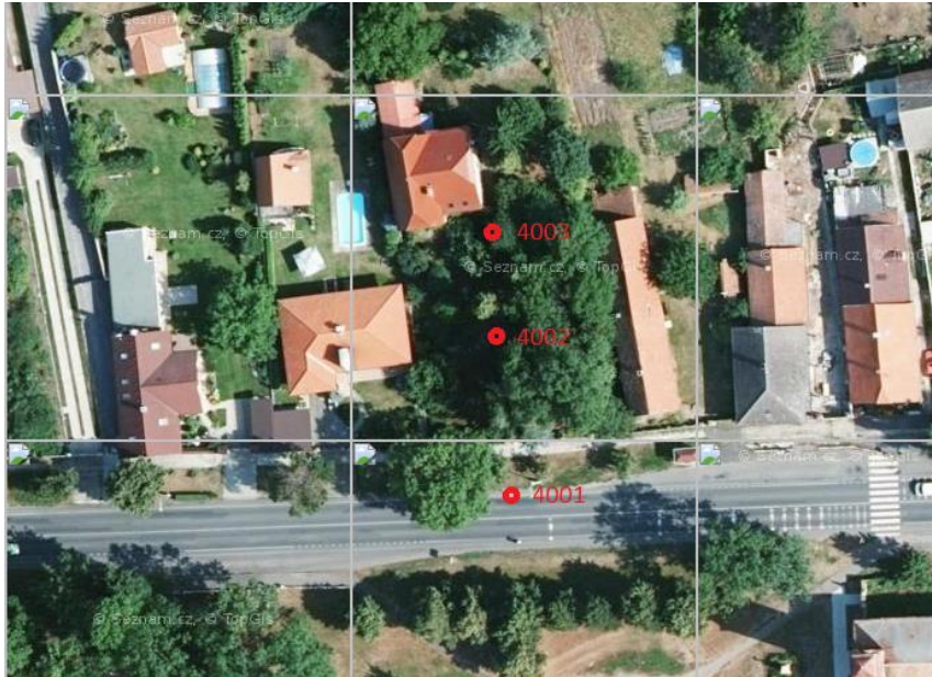
Obr. 10: Ortofoto s body volného polygonového pořadu [1]
