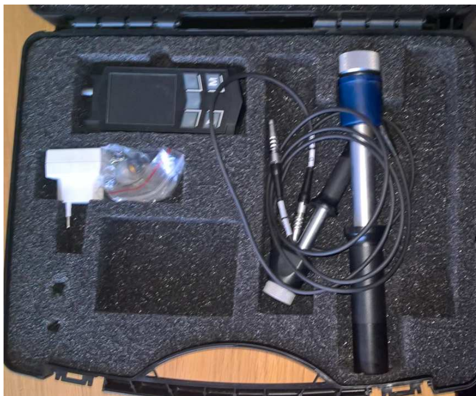
Obrázek 19 - Přenosný tvrdoměr KT-C s odrazovou sondou
