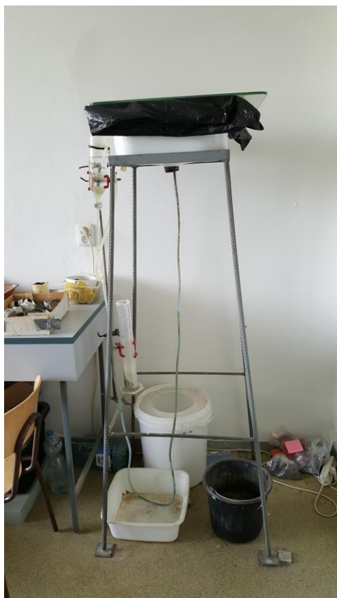
Obrázek 25. Pískový tank, který byl použit pro sací tlaky do -0,5 m.
