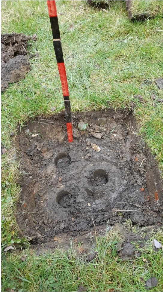
Obrázek 28. Spodní Kopeckého válečky s neporušenými vzorky v půdě ve dvoře (sonda D).
