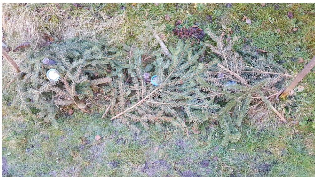
Obrázek 31. Ochrana tenzometrů před přizemními mrazíky na jaře 2017.
