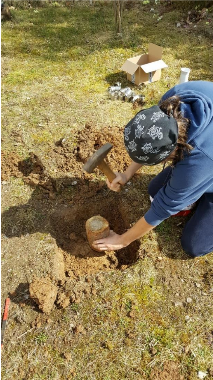
Obrázek 27. Odběr neporušených vzorků na straně svahu (sonda S).
