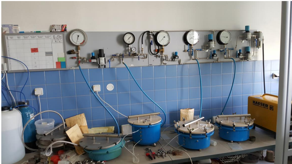
Obrázek 26. Přetlakové nádoby použité pro tlaky 0,1-5 bar.
