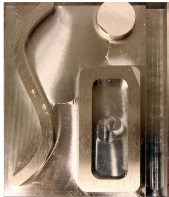
Obr. 5.18: Obrobený testovací dílec iMachining
