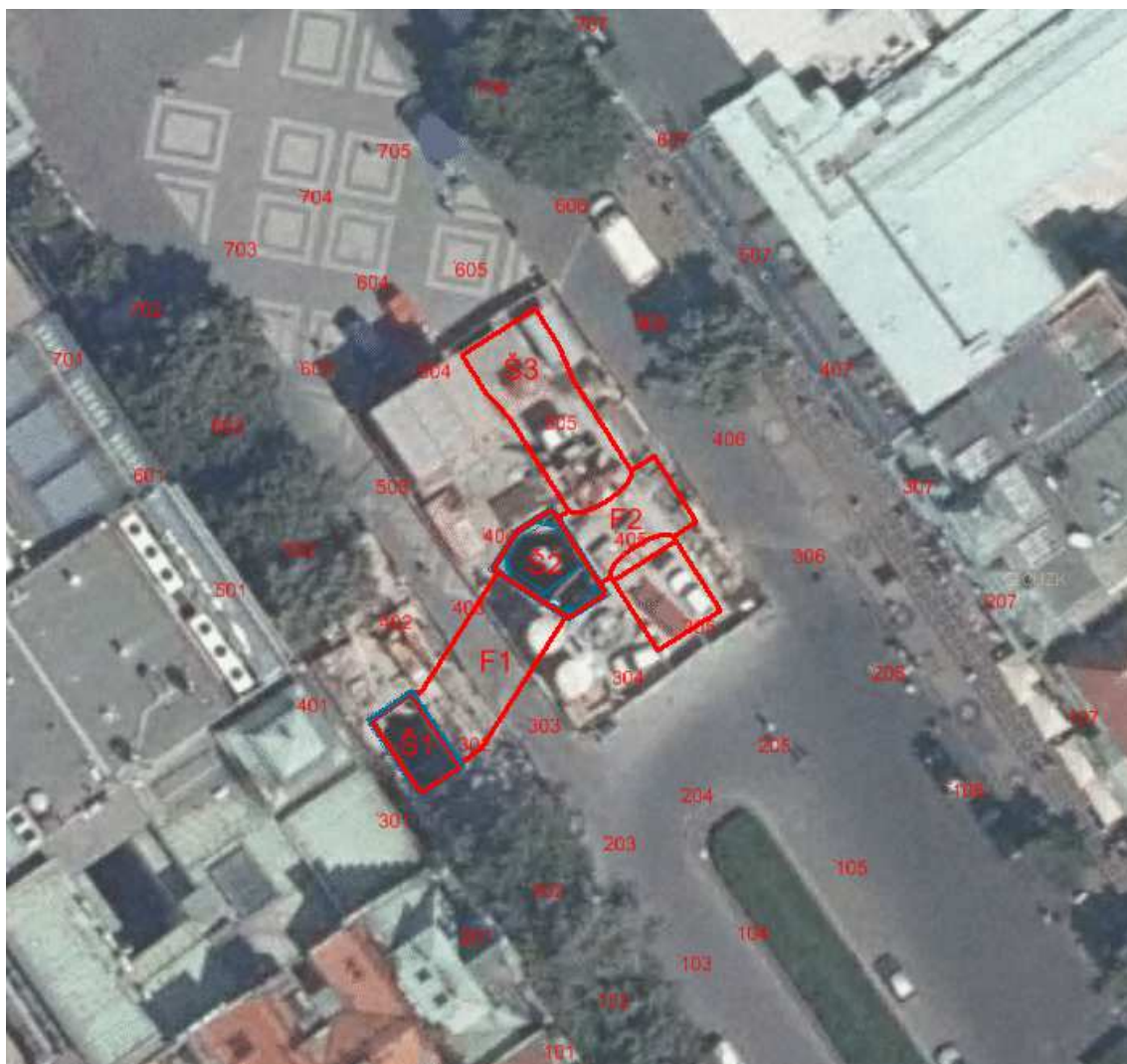
Obrázek 2: Sledovaná výšková síť a budovaná stavba
