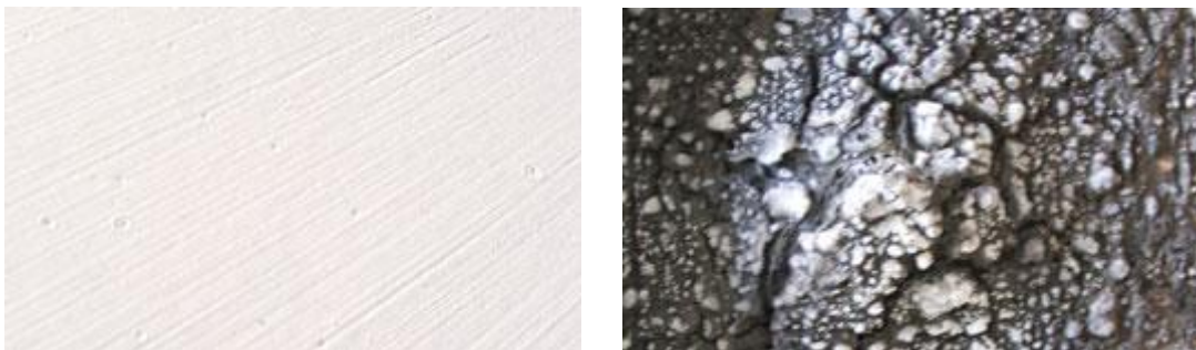
obr. 2 Nátěr Plamostop P9 / nátěr po působení ohně [6]
