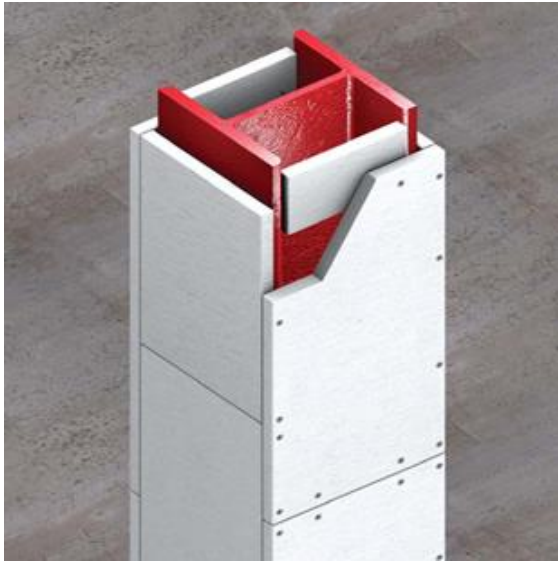
obr. 3 Obklad ocelového sloupu deskami PROMATECT L [8]
