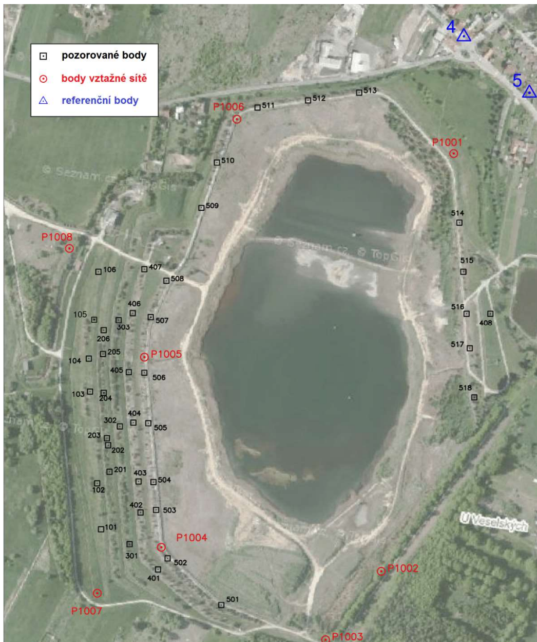
Obr. 3.7 Rozmístění bodů monitorovací sítě
