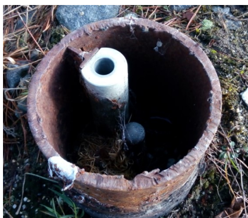
Obr. 3.8 Vrt s navařeným profilem „T“ a hliníkovým válečkem
