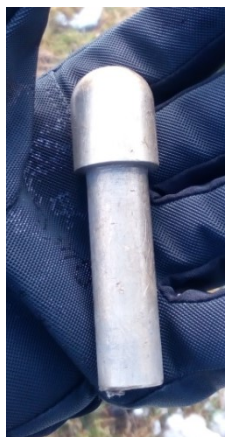
Obr. 3.9 Přenosný mosazný čep
