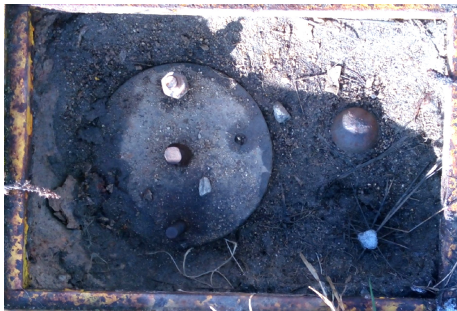
Obr. 3.6 Stabilizace bodů vztažné sítě 1004, 1005 a 1006
