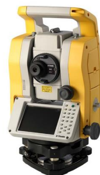
Obr. 8: Totální stanice Trimble M3
