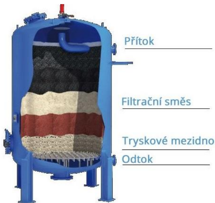
Obr. 7 Schéma tlakového filtru s aktivním uhlím [49]
