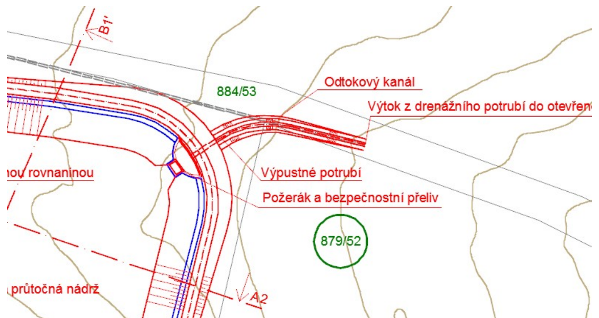
obr. 6.10 Schéma odtokového kanálu v návaznosti na okolí (podklad: katastrální mapa a digitální model reliéfu 5. generace)
