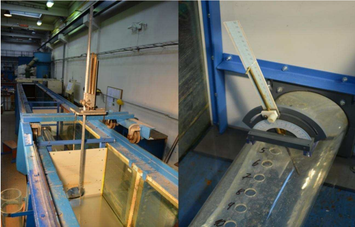
Obrázek 8 Hrotová měřítka, pomocí nichž byl zjišťován průběh a úroveň hladin ve fyzikálním modelu [10]
