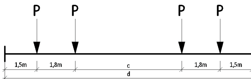
Obr. 4.1: Základní schéma čtyřnápravového vozu
