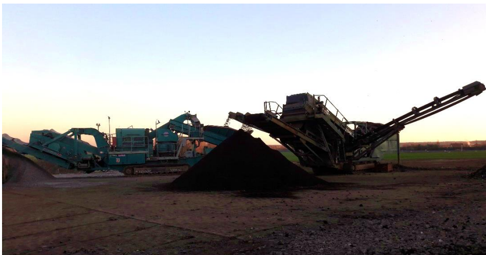
Obrázek 8 Recyklační linka - Třídíč (vpravo), drtič (vlevo vzadu); deponie Horky u Čáslavi 27. 3. 2017
