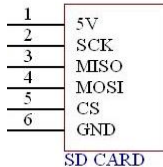
Obrázek 12:SD slot. Převzato z [23] Obrázek 13: SD slot – piny. Převzato z [23]
