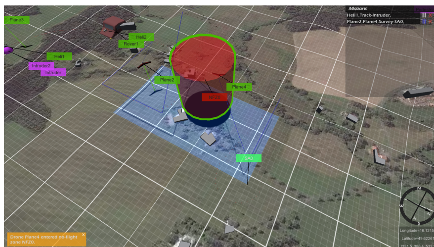
Obrázek 21 Sledování oblasti SA0 tak, aby se vyhnulo zvýrazněné bezletové zóně. Zároveň se Plane4 snaží dostat z bezletové zóny, ve které se nachází.
