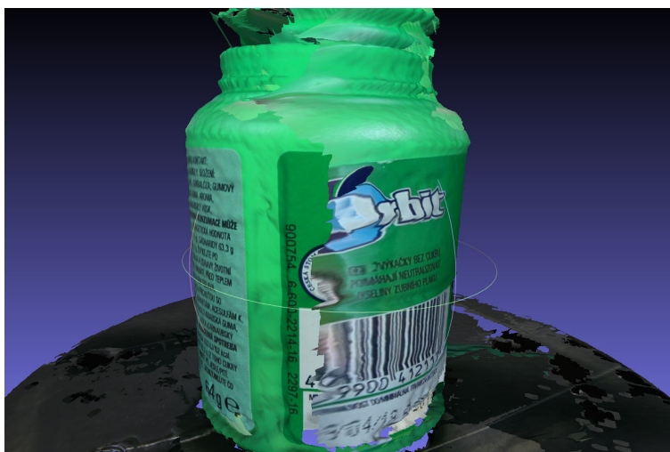
Obrázek 7.10: Finální scéna - balení žvýkaček 2. V tomto záběru je patrné, že skener není stavěn pro skenování průhledných a průsvitných objektů, v tomto případě jsou části modelu zdeformovány tím, že laserové paprsky prošly obalem a odrážely se od žvýkaček uvnitř.
