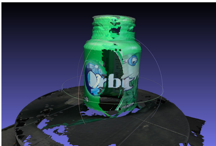
Obrázek 7.9: Finální scéna - balení žvýkaček 1. Zde je vidět, že skener má občas problémy se skenováním velmi lesklých objektů, proto na přední části modelu chybí trojúhelníky.
