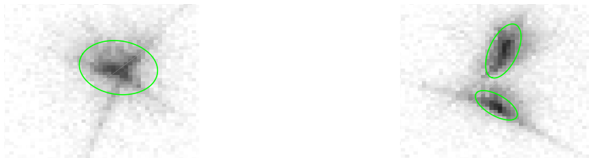
Obrázek 4.3: Ilustrace slynutí dvou různých svazků. V pravém i levém snímku se nachází typově stejné laserové svazky. Na levém obrázku dopadly na stínítko příliš blízko sebe. V tomto případě nejsme schopni rozlišit příspěvek obou svazků a detekujeme pouze jednu stopu.
