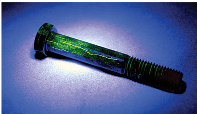
Obrázek 1.1: Indikace defektu magnetickou metodou práškovou[1]
