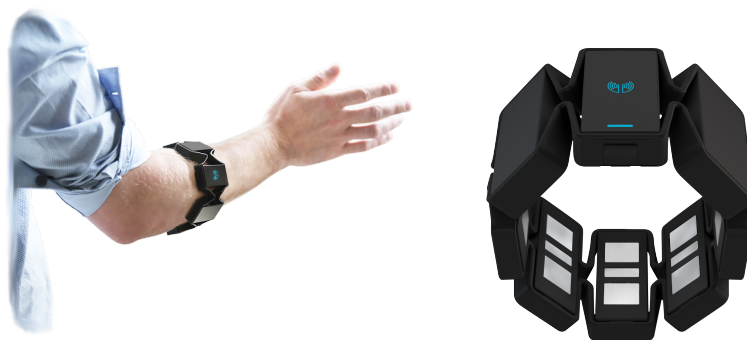
Obrázek 2.5.2: Zařízení Myo armband a jeho upevnění na ruce.
