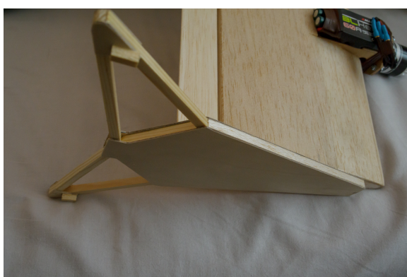
Obrázek 3.7: Vylepšení konstrukce trojúhelníků.
