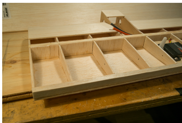
Obrázek 3.4: Pohled na vnitřní konstrukci křídla.
