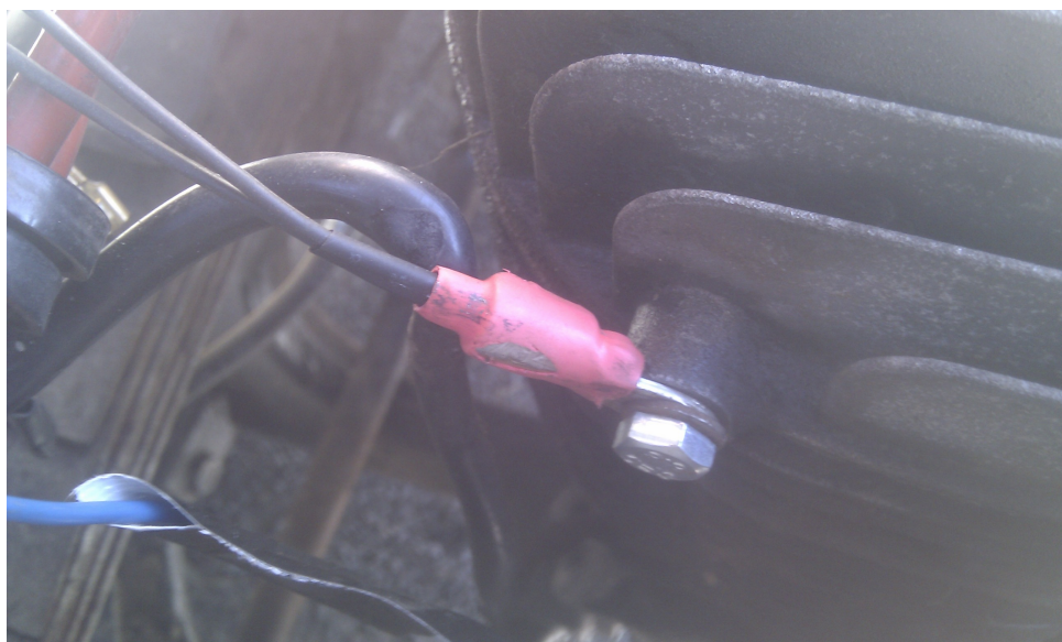
Obr. 71: Detail montáže senzoru teploty motoru k hlavě válce
