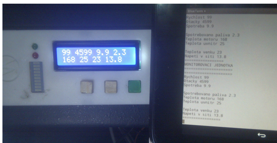
Obr. 46: Testovací sekvence na LCD a zároveň přijata pomocí chytrého zařízení, jednotka nainstalována ve voze
