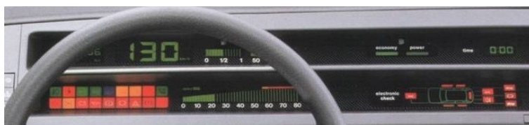
Obr. 8: Palubní sdružená informační jednotka Fiat Tipo[23]
