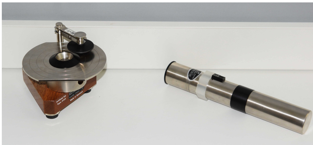
Obr. 2.1: Vlevo Artificial Ear Brüel & Kjær 4153 s Adaptor DB 0843 a mechanismem pro upnutí sluchátek, vpravo Pistonphone
