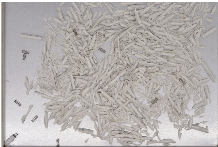
Obrázek 3.6. Pořízený obraz pružin a okolní imitace magnoxu, ve kterém jsou vyhledány pružiny.
