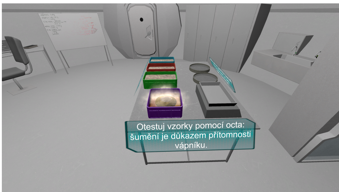
Obrázek B.8. Test hornin na přítomnost vápníku.
