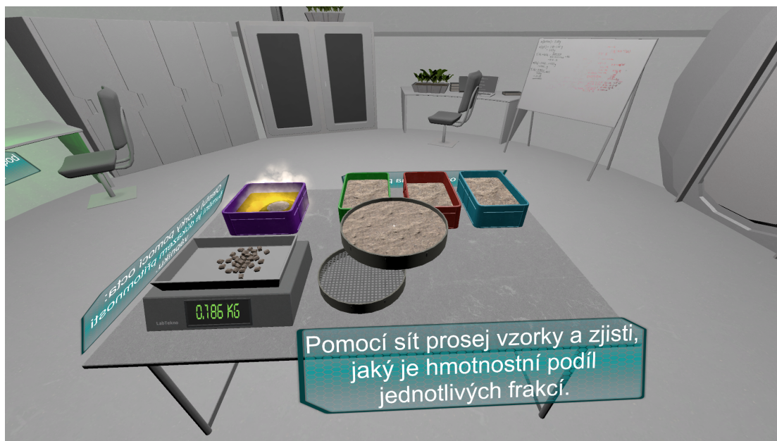
Obrázek B.9. Test zrnitosti vzorků hornin odebraných na povrchu Měsíce.
