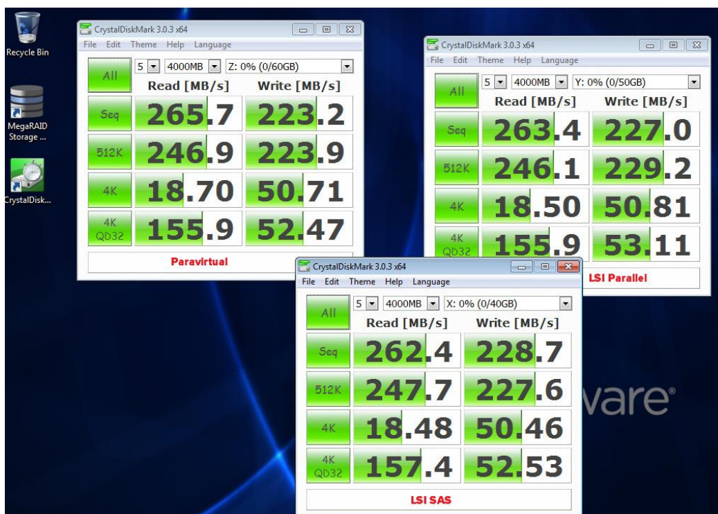
Obr. 13 - srovnání variant připojení HDD, 4 GB testovací soubor, jeden disk Seagate ES.3 2 TB připojený přes HW RAID s read-write CacheCade (tvořenou jedním netočivým diskem Intel 530 s kapacitou 240 GB).
