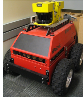
(b) : Reálný robotický model ATRV vybavený laserovým dálkoměrem [18]
