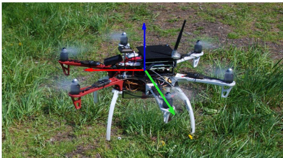
Obrázek 6.1: Hexakoptéra a její souřadný systém
