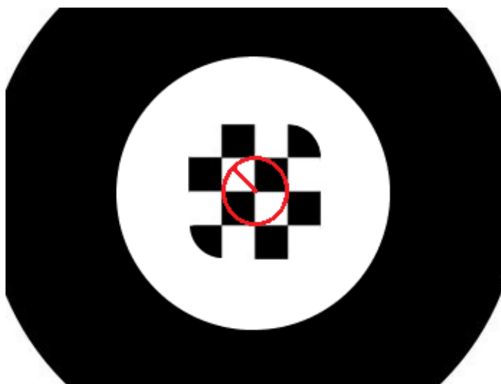
Obrázek 5.4: Červeně: kružnice opsaná 4 rohům šachovnice
