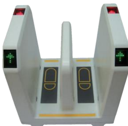
Obrázek 13 - Detektor kovů v obuvi MagShoe 3G/4 (zdroj: http://tactical5.com/ )
