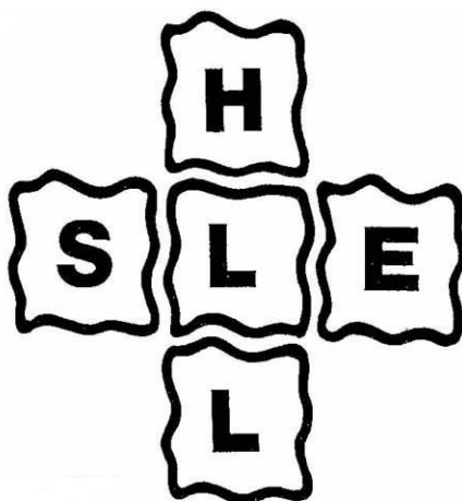
Obrázek 18 - Model SHELL, kde nerovné stěny jednotlivých prvků zobrazují poměry na rozhraní (zdroj: https://blogs.cmdn.dundee.ac.uk/humanfactors/files/2013/04/SHELL.jpg )
