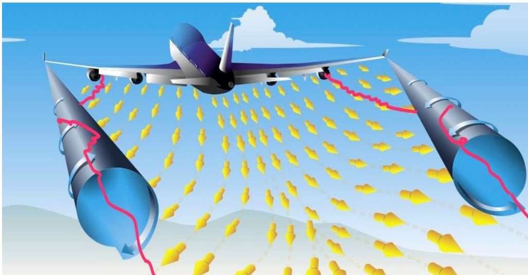
Obrázok 5.1: Turbulentné prúdenie za lietadlom [68].
