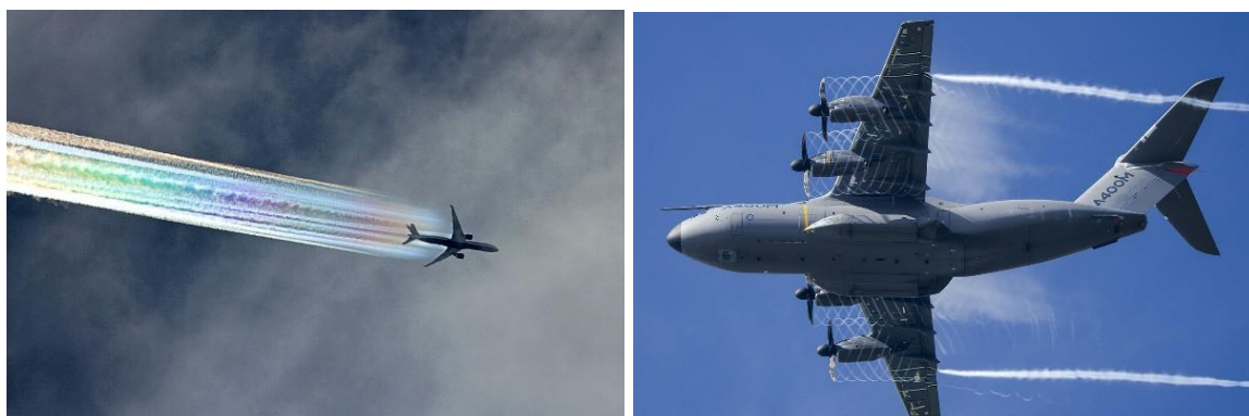
Obrázok 3.4: Aerodynamické kondenzačné stopy [40,41].
