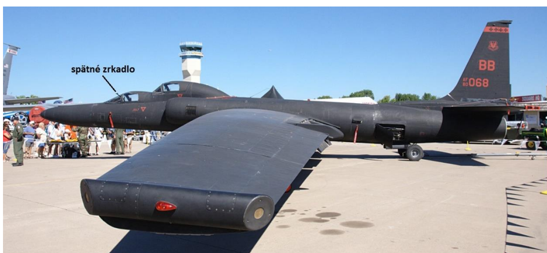
Obrázok 6.1: Lockheed U-2 so spätným zrkadlom zistenie vzniku kondenzačnej stopy za lietadlom [74].
