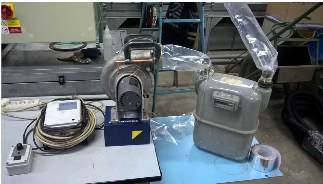
Obr. 18 – Napojení ventilátoru přes plynoměr do vzduchotechnického potrubí
