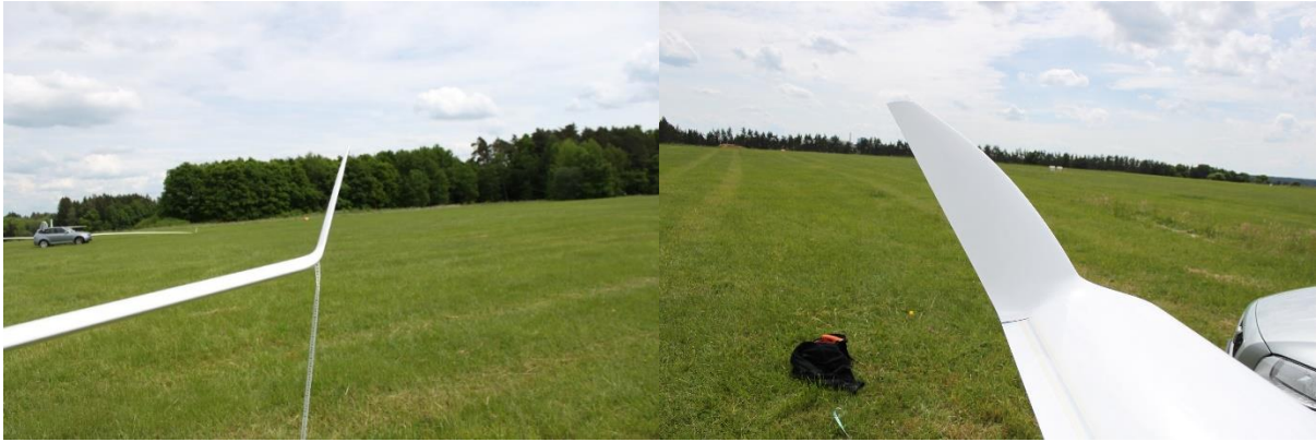
Obrázek 19 Winglet kluzáku Arcus M pohled zepředu (vlevo), od trupu (vpravo)
