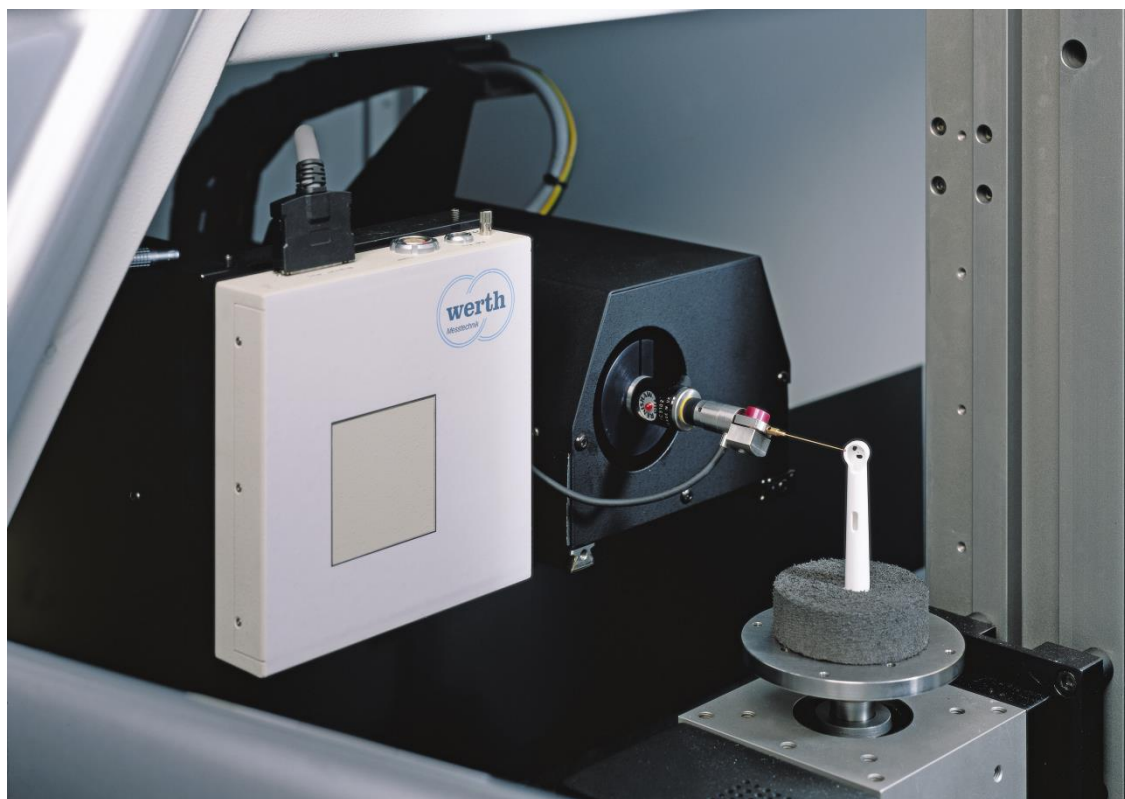
Obrázek 6 Měření dílce s použitím doplňkového dotykového senzoru [14]
