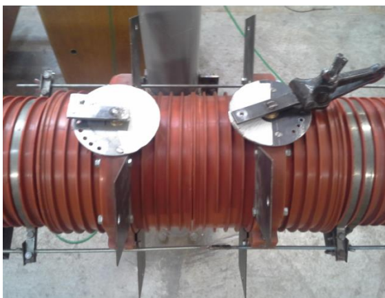
Obr. 2-3 Soustava klapek zapojená do série pro měření tlakových rozdílů
