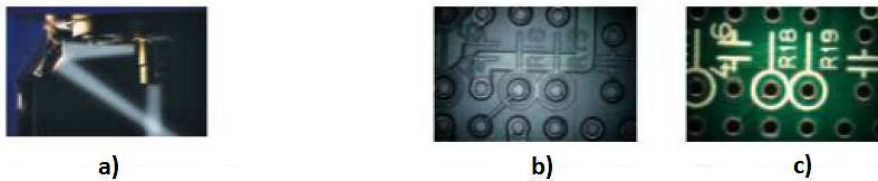
Obr. 20 Šikmé osvětlení a) nastavitelné šikmé přepínatelné dopadající osvětlení, b) objekt nasvícený svislým osvětlením, c) objekt nasvícený šikmým osvětlením [9]
