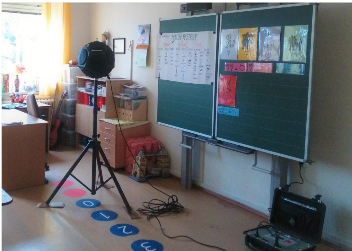
Obrázek 9: Měření doby dozvuku v učebně II. A – zapojení reproduktoru a zesilovače
