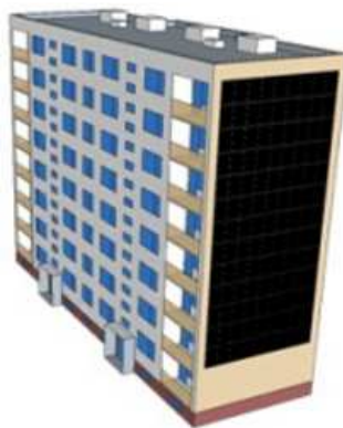
Obr.5 Příklad umístění fve na štítech, převzato z [4]
