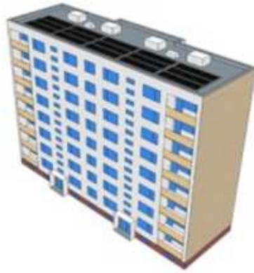
Obr.4 Příklad aplikace fotovoltaické krytiny, převzato z [4]
