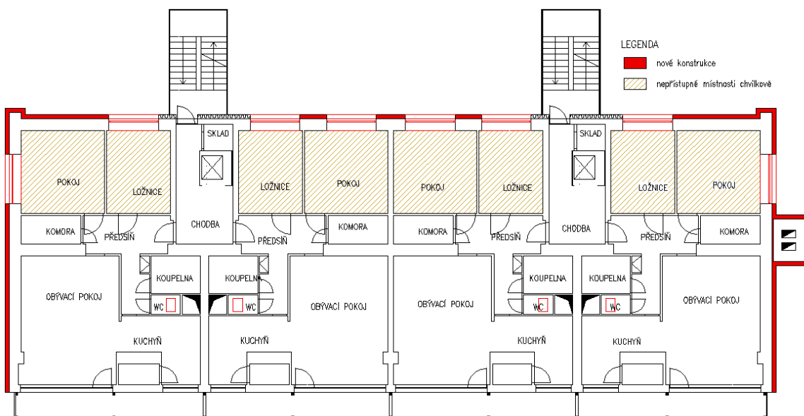
Obr.37 Schéma postupu rekonstrukce - III. etapa, suterén - zateplení, výplně otvorů
