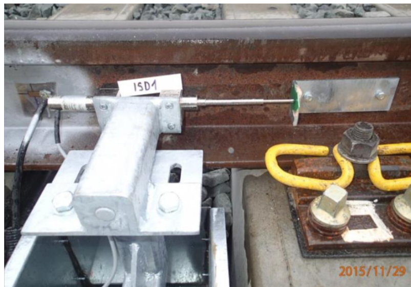
Obr. 123 Snímač posunu koleje – ISD1 [12]
