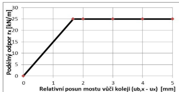
Obr. 23c Závislost podélného odporu přímého upevnění na relativním posunu koleje k mostu (60E1, DFF 300, Skl B 15, rozdělení „u“) [15]
