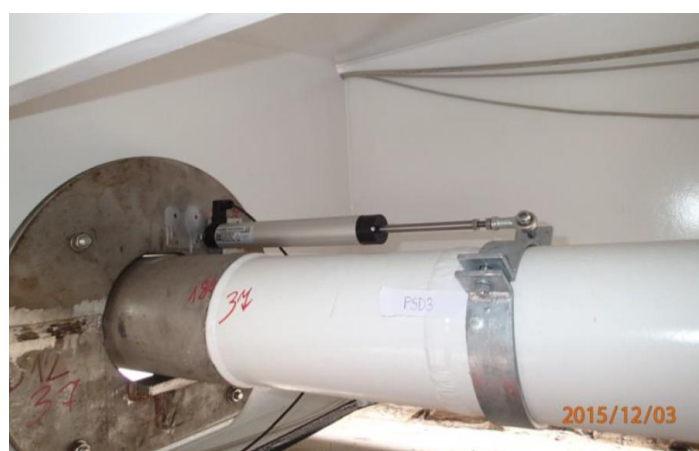
Obr. 119 Potenciometrický snímač dráhy PSD3 [12]
