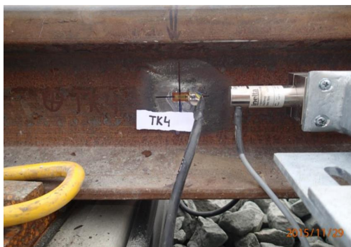
Obr. 126 Tenzometr na kolejnici v bodu TK4 [12]
