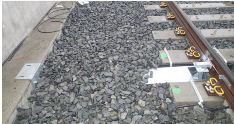
Obr. 122 Konzola pro připevnění snímače ISD1
