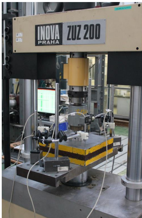
Obrázek 7 Celkový pohled na sestavu č. 1 při zkoušce podle OTP
