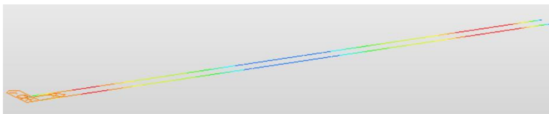
Obr. 244: Znázornění částí mostovky dosahujících maximálního zrychlení a výkmitu při dynamickém zatížení s frekvencí 3,0309 Hz.
